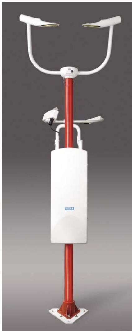
维萨拉FS11P天气现象传感器适用于机场跑道视程(RVR)、航空和气象能见度以及天气现象的观测等应用领域，是一种综合型的机场跑道视程、航空气象能见度和天气现象传感器。它集成多种功能于一身，能够进行多种重要参数的测量。此传感器能见度的测量范围能够达到75公里，包括大气消光系数、降水类型和强度的实时天气，以及背景光亮度（可选）等方面的数据。
