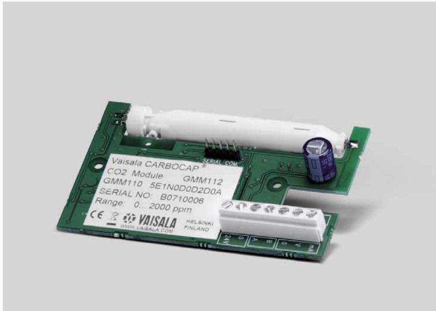
维萨拉CARBOCAP®二氧化碳模块GMM112是基本型的CO<sub>2</sub>测量模块。
