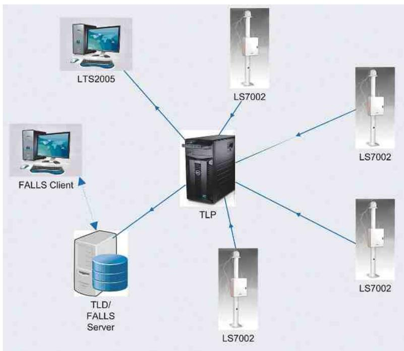
典型的维萨拉低频高精度闪电探测网络配置采用TLP100。维萨拉LF + VHF网络则需要选用TLP200。每个网络由四个或更多传感器组成（与需要覆盖的面积有关）。每个传感器向TLP实时发回已探测到的闪电所生成电磁信号数据。TLP利用来自多个传感器的数据根据地理定位算法找出每次闪电事件的最优位置解决方案。此外，还为每个解决方案提供各种参数和相关特征。来自TLP的闪电数据可发送给各种应用进行显示、存储和分析。
